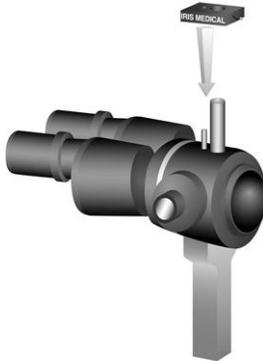
5. Détacher le filtre de sécurité oculaire de sa position de rangement. Placer le SLA sur la tige du biomicroscope. Serrer avec la vis à main.
